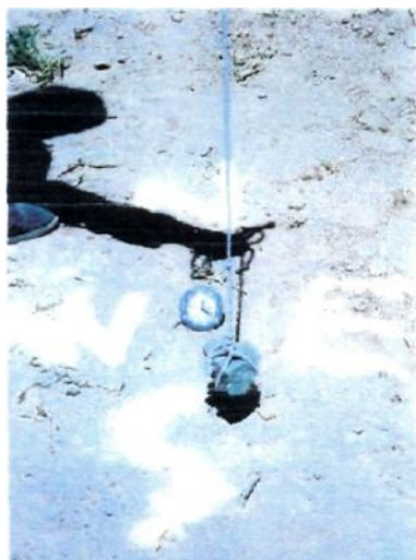
Фото 11 - Определение направления на юг с использованием веревки с отвесом
